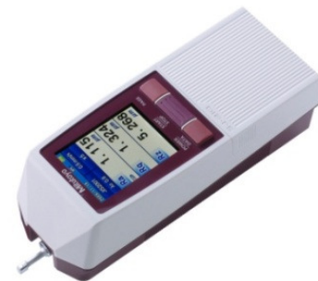
Fig. 3. Surf Test (MITUTOYO SJ-210)
